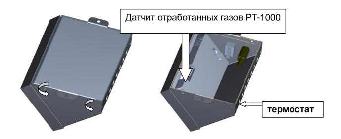
Монтирование проводов к комнатному термостату или к датчику выхлопных газов PID осуществляется при откручивании нижней части контроллера. Провода термостата монтируем в предназначенном месте с помощью зажимов, а датчик выхлопных газов в месте, обозначенном PT1000.
