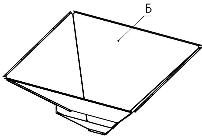
Соединить деталь 6 с деталями 7 и 8. К созданной конструкции прикрепить детали 9 и 10. Все соединения выполняются на винт М5х30 и гайку с шайбами.
