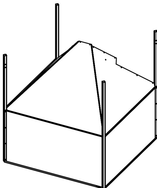
Перегородки фиксируются на ножках при помощи винтов М5х40 и гаек с шайбами. (Только в модели S1200L).
